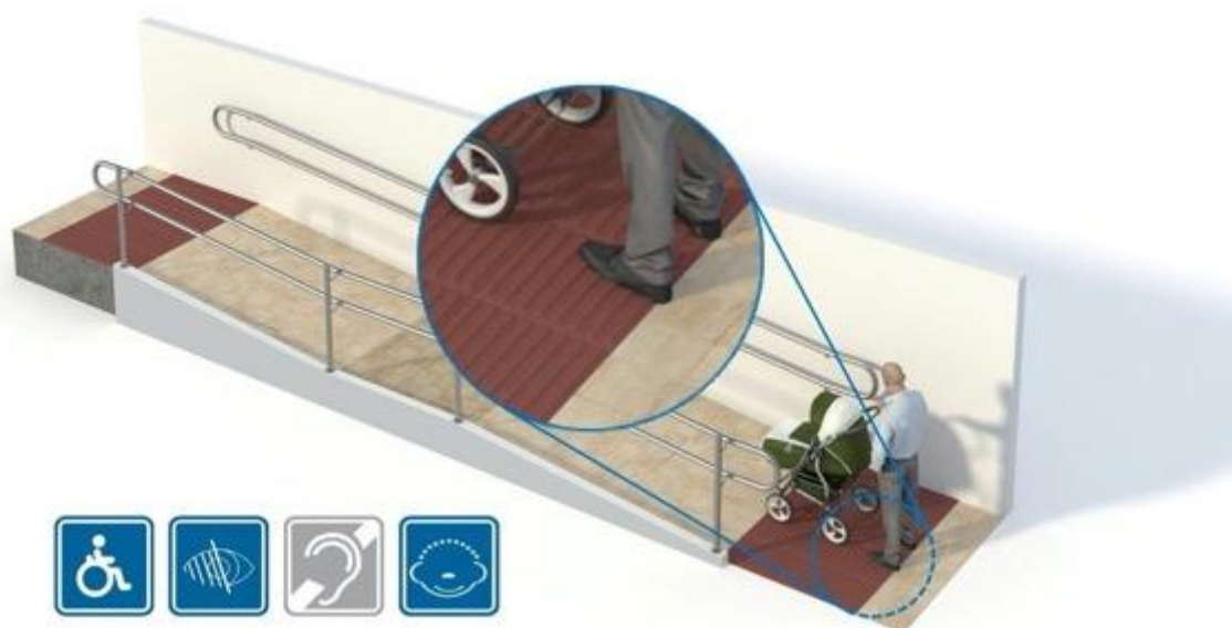
Imagen 4. Detalles de diseño. Uso de pavimentos tacto-visuales
