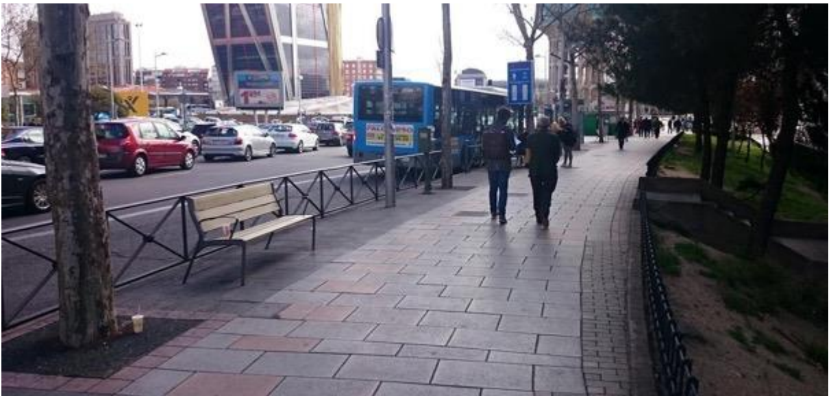
Imagen 9. Configuración en bandas en la plaza de Castilla. Los pavimentos diferenciados delimitan las bandas de mobiliario y el itinerario peatonal accesible y, en este caso, una banda de borde de acera
