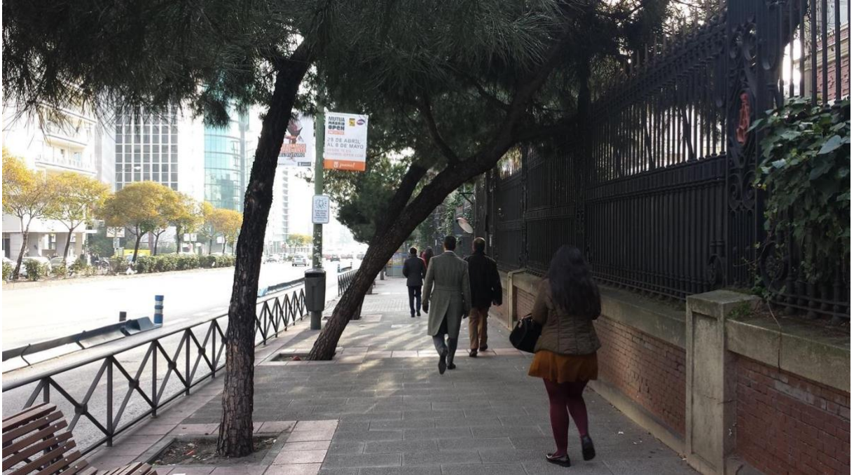
Imagen 6. La progresiva pérdida de verticalidad del arbolado o el crecimiento de sus ramas puede limitar y reducir el ancho libre de paso (gálibo) de las aceras
