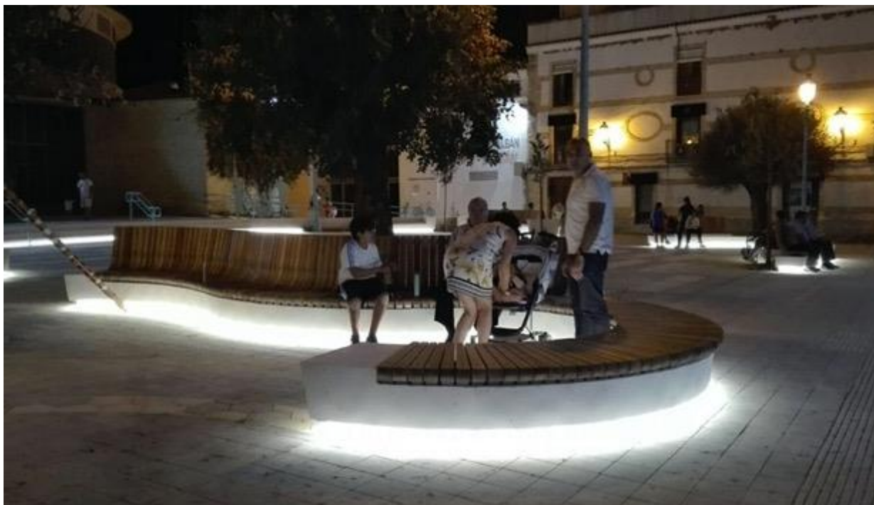
Imagen 16. Iluminación ornamental que permite la orientación en la deambulaci3n nocturna en la Plaza de Andaluc3a. Evitando en todo momento los deslumbramientos y reforz3ndose con una iluminaci3n ambiental en altura complementaria, en Montalb3n de C3rdoba
