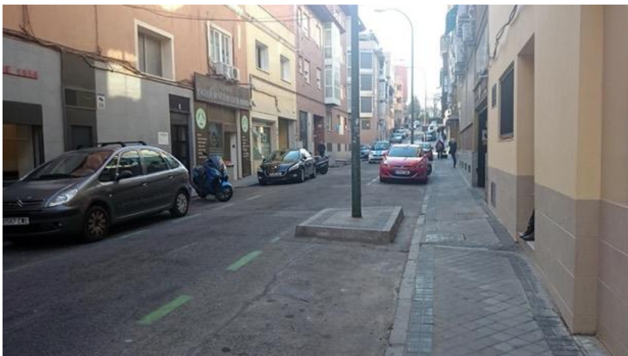
Imagen 14. Calle de Saturnino Calleja. En este caso, ante la reducida anchura de la acera, se ha optado por el traslado de soportes de alumbrado público a la banda de aparcamiento
