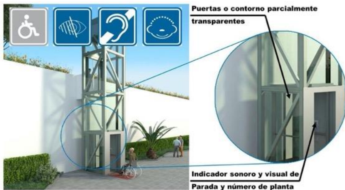
Imagen 6. Detalles de diseño. Comunicación visual con el exterior
