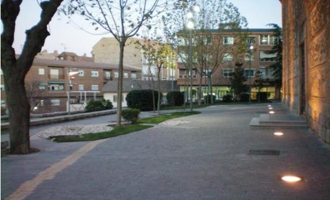
Imagen 14. Iluminación ornamental que singulariza el edificio en su entorno. Este tipo de focos deben situarse fuera del itinerario peatonal para evitar deslumbramientos
