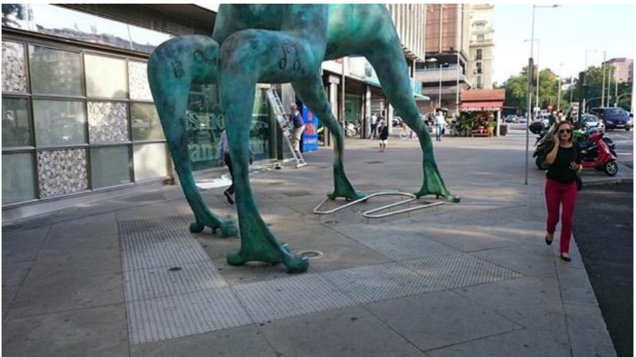
Imagen 29. Detalle de señalización de escultura en el itinerario peatonal accesible en el Paseo de Recoletos. La ubicación inadecuada, invadiendo el IPA puede generar tropiezos que intentan evitarse añadiendo elementos que tampoco corresponden
