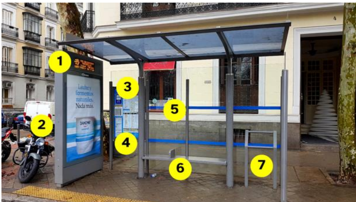
Imagen 4. Elementos y dispositivos relacionados con la accesibilidad universal en una marquesina: 1, display con información visual de servicio en tiempo real; 2, activador de la información sonora; 3, información de líneas, rutas, horarios, etc.; 4, código QR de acceso a la información de servicio; 5, bandas de señalización sobre los vidrios; 6, banco con apoyabrazos; 7, apoyo isquiático
