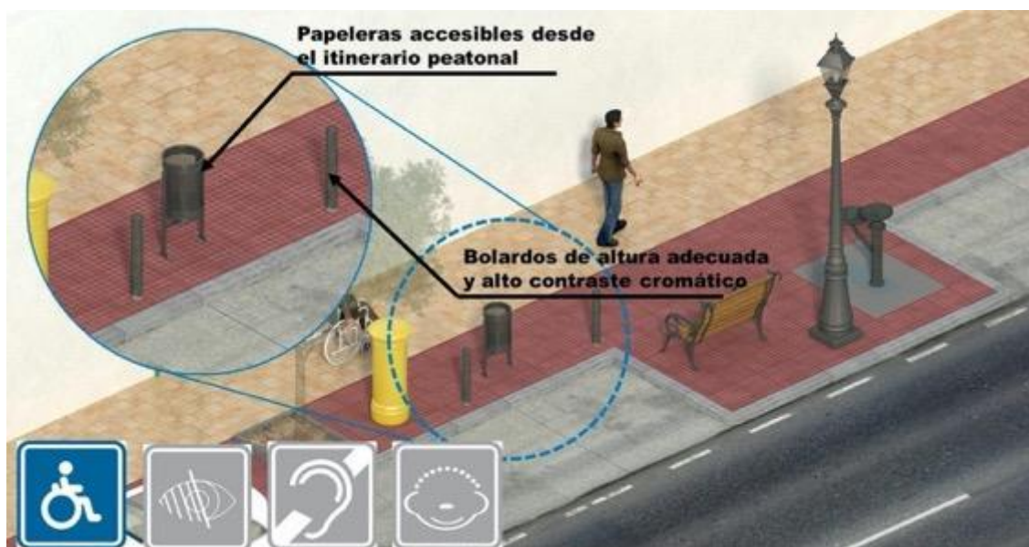
Imagen 10. Detalles de diseño de bolardos y papeleras en banda de mobiliario
