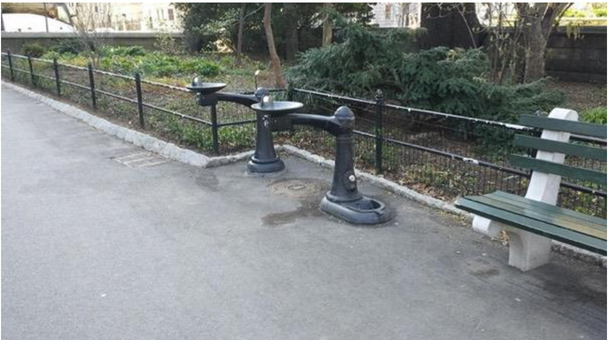
Imagen 19. En parques y jardines es interesante promover una disposición del mobiliario en bandas adosadas a los laterales. Incluso se pueden generar espacios específicos, como los de la imagen, en los que se amplíe el ancho de la plataforma peatonal para albergar las fuentes y los bancos
