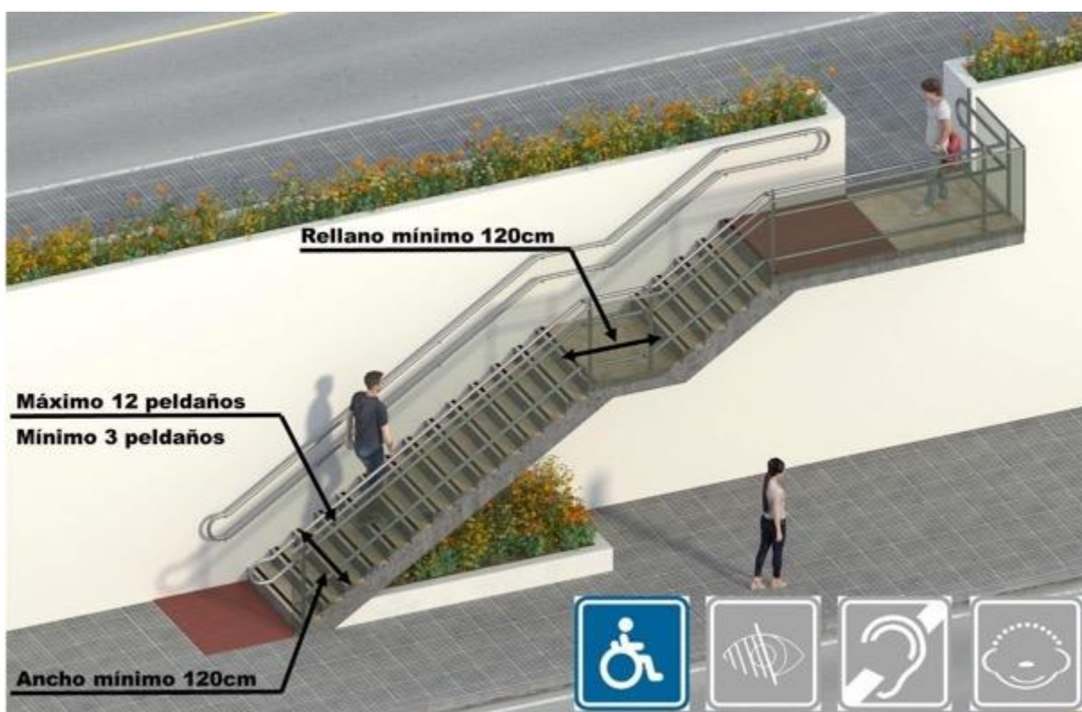
Imagen 3. Geometría de una escalera accesible
