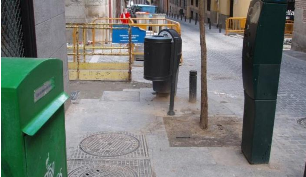
Imagen 9. La imagen muestra una calle con un espacio reducido de circulación en la que posteriormente se incorporan elementos de mobiliario (papelera, buzón de correos y parquímetro) que comprometen aún más sus condiciones de accesibilidad
