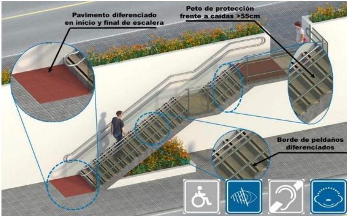
Imagen 7. Uso de pavimentos señalizadores en escaleras
